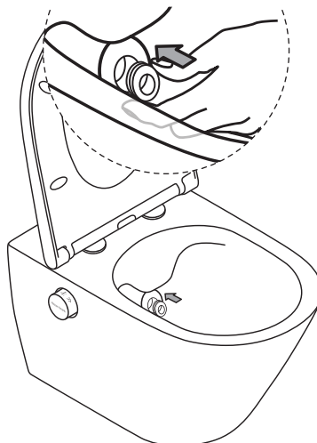
G. Po vyčištění nasadíte stabilizační kroužek mycí trysky zpět na místo a ujistěte se, že je ve správné poloze. Výčnělek na kroužku by měl být dole.
