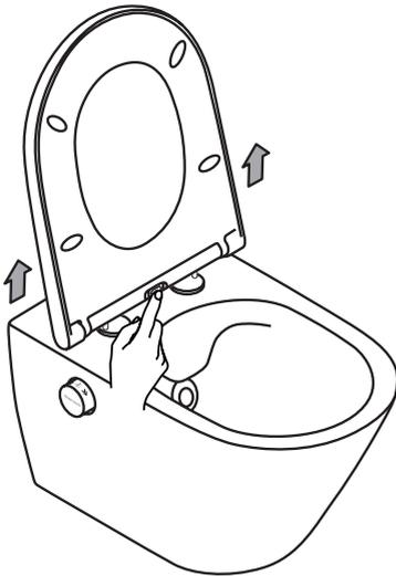
**A.** Zum Lösen des WC-Brettes drücken Sie die Entriegelungstaste und ziehen Sie das WC-Brett nach oben.
