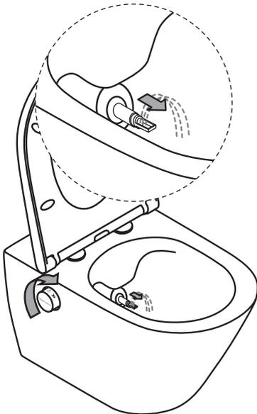
**H.** Drehen Sie dann den Drehknopf zur Aktivierung des Waschwasserstrahls nach vorne, so dass die Düse mit geringem Wasserdruck austritt.
