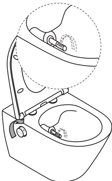
**A.** Um die Waschdüse zu entfernen, drehen Sie den Aktivierungsknopf für den Waschwasserstrahl leicht nach vorne, so dass die Düse bei niedrigem Wasserdruck herausgleitet.
