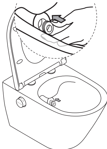
G. Po wyczyszczeniu umieść z powrotem pierścień stabilizujący dyszę myjącą zwracając uwagę na jego właściwą pozycję. Wypustka na pierścieniu powinna znajdować się na dole.
