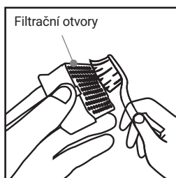
C. K odstranění prachu a špíny použijte k čištění dezodorátoru zubní kartáček nebo jiný malý kartáč.
