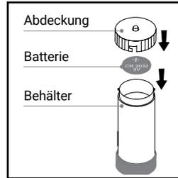
**B.** Öffnen Sie die Abdeckung und legen Sie die Batterie mit dem Pluspol nach oben ein. Die geeignete Batterie ist CR 2032 3V.
