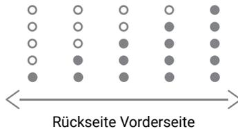
Drücken Sie die Taste "∧" in den Einstellungen der Düsenposition, um sie nach vorne zu schieben. Bei jedem Druck fährt die Düse um 1 Ebene weiter aus. Mit der Taste "∨" wird die Düse wieder eingeschoben.
