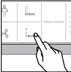
Drücken Sie die angezeigte Taste, um einen Waschvorgang mit Pulsierende Reinigung zu starten.
