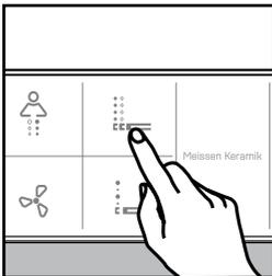
Drücken Sie die angezeigte Taste, um den oszillierenden Waschvorgang zu starten.
