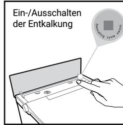
**B.** Drücken Sie die Entkalkungstaste, um die Entleerung des Tanks zu starten. Dies wird von einem unterbrochenen Tonsignal begleitet. Die Entleerung des Tanks ist nach ca. 30 Sekunden beendet.
