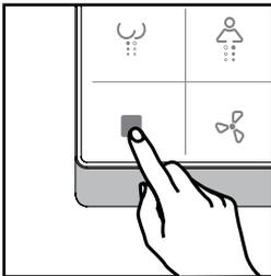
A. Trennen Sie die Waschwanne mit dem Schalter unter der Glasrückwand vom Stromnetz und halten Sie dann die Stopptaste gedrückt, bis die LEDs auf der Fernbedienung zu blinken beginnen.
