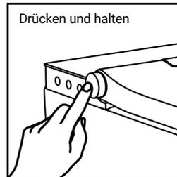
**B.** Halten Sie den Steuerungsdrehknopf gedrückt, bis Sie einen langen Piepton hören, der anzeigt, dass der Steuerungsdrehknopf korrekt mit dem Gerät synchronisiert wurde. Wenn der Kopplungsversuch fehlgeschlagen ist, versuchen Sie es erneut. Bei erfolgloser Verbindung setzen Sie sich mit dem Service in Kontakt.
