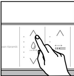
Drücken Sie "∧" in der "Wasserdrucksteuerung" während der Standardreinigung, um die Druckintensität zu erhöhen; drücken Sie "∨", um den Wasserdruck zu verringern.
