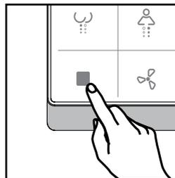
Drücken Sie die Taste "Stopp", um die Standardreinigung zu beenden, oder warten Sie 3 Minuten, bis der Vorgang automatisch beendet ist.
