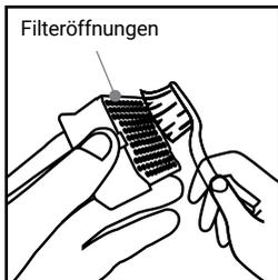
**C.** Reinigen Sie den Geruchsentferner mit einer Zahnbürste oder einer anderen kleinen Zahnbürste, um Staub und Schmutz zu entfernen.
