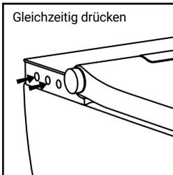
**A.** Drücken Sie den Netzschalter und die Taste für die Standardreinigung gleichzeitig. Es sollte ein langer Ton zu hören sein. Wenn er nicht da ist, versuchen Sie es erneut.
