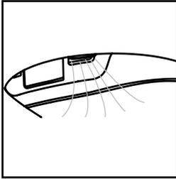
Die Trocknungsfunktion wird aktiviert, die Trocknungsdüse öffnet sich und die warme Luft wird aus der Düse ausgestoßen.
