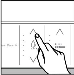
Drücken Sie "∧" in der "Wasserdruckregelung" während der Intimpflege für Frauen, um die Druckintensität zu erhöhen; drücken Sie "∨", um den Wasserdruck zu verringern.
