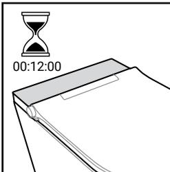
**E.** Der Entkalkungsvorgang wird automatisch durchgeführt und ist nach ca. 12 Minuten abgeschlossen. Der gesamte Entkalkungsvorgang wird von einem unterbrochenen Tonsignal begleitet. Wenn der Entkalkungszyklus abgeschlossen ist, wird das Tonsignal ausgeschaltet.
