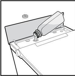
**C.** Öffnen Sie den Einfüllstopfen und gießen Sie den Entkalker wie in der Abbildung angegeben ein (ca. 200 ml). Verwenden Sie einen Entkalker für Kaffeemaschinen und Wasserkocher. **Die maximale Menge an Entkalker, die in die Waschanlage geschüttet werden kann, beträgt 250 ml.**
