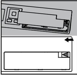
A. Die Abdeckung der Batterie befindet sich auf der Rückseite der Fernbedienung. Um sie zu öffnen, schieben Sie den Schieber nach links, wie in der Abbildung gezeigt.
