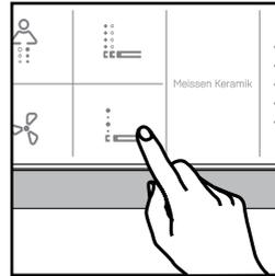
Drücken Sie die Taste für den Pulsierende Reinigung erneut, um ihn zu beenden, oder warten Sie 3 Minuten, bis der Pulsierende Reinigung automatisch beendet wird.
